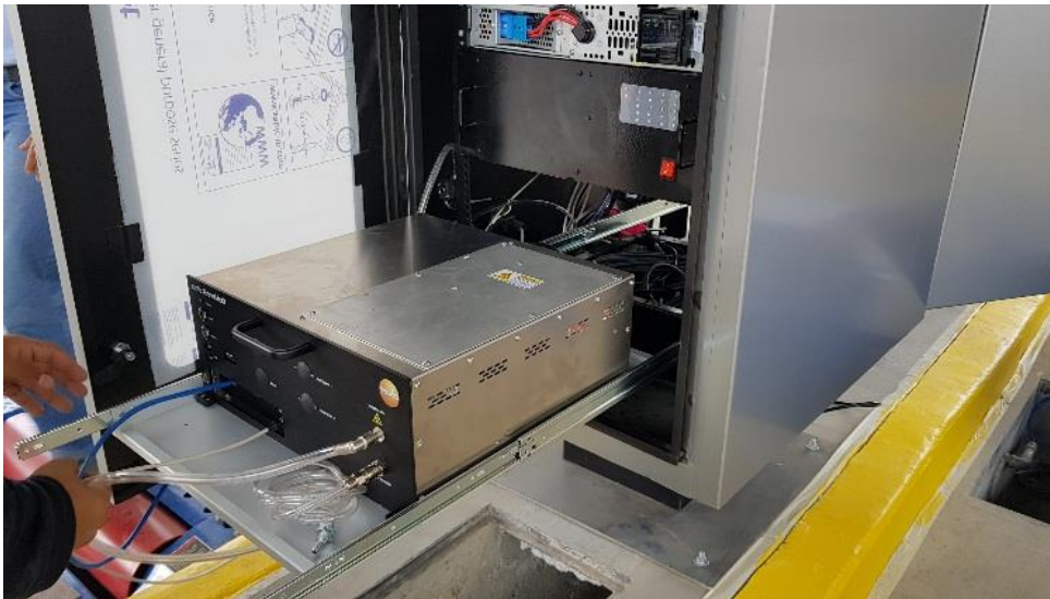
testo NanoMet3 instalado en un gabinete de 19" junto con el sistema de medición de gases
